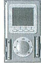
Vuelva a colocar las pilas respetando la polaridad (dirección).
